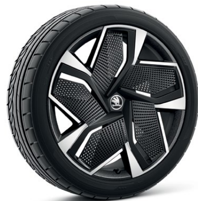
21" kola z lehké slitiny Vision (antracitová) s aero kryty disk: 8,5J × 21" ET 40, 9J × 21" ET 42* pneu: 235/45 R21, 255/40 R21*
