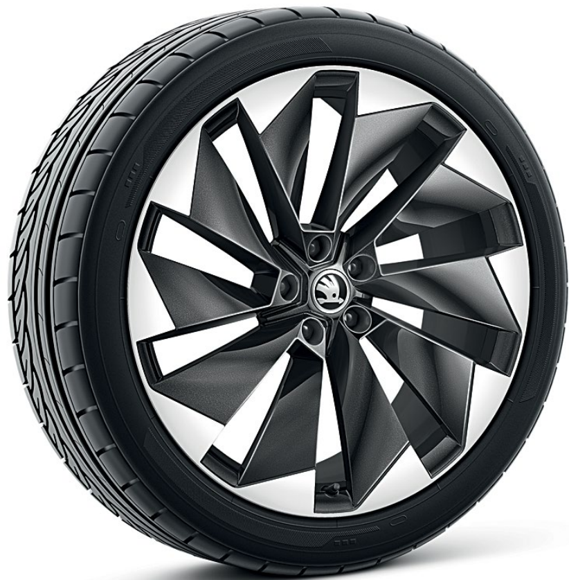
21" kola z lehké slitiny Supernova (antracitová) disk: 8,5J × 21" ET 40, 9J × 21" ET 42* pneu: 235/45 R21, 255/40 R21*
