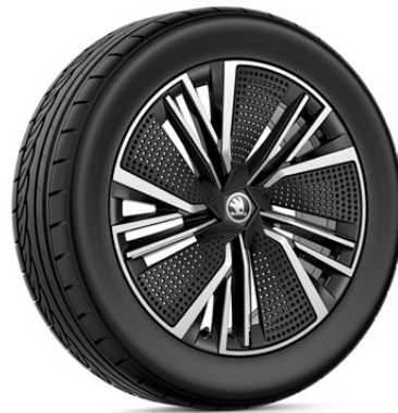
20" kola z lehké slitiny Neptune (antracitová) s aero kryty disk: 8J × 20" ET 40, 9J × 20" ET 40* pneu: 235/50 R20, 255/45 R20*
